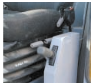
写真10 ダンパコントロールレバー
