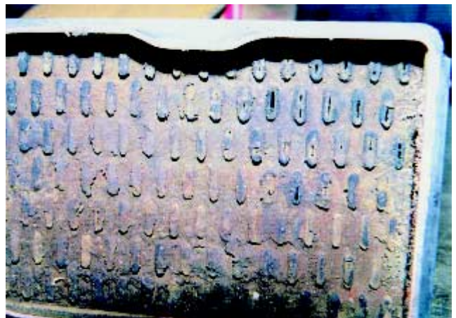
写真2 スケールによるラジエータ目詰まり (ラジエータトップタンク側断面)
