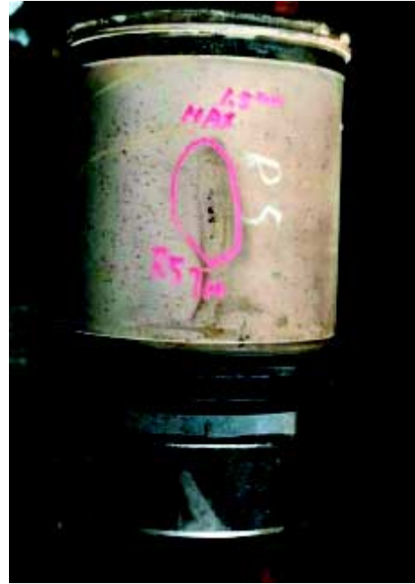
写真1 市販クーラント使用例(エンジンベンチテスト 500h)
