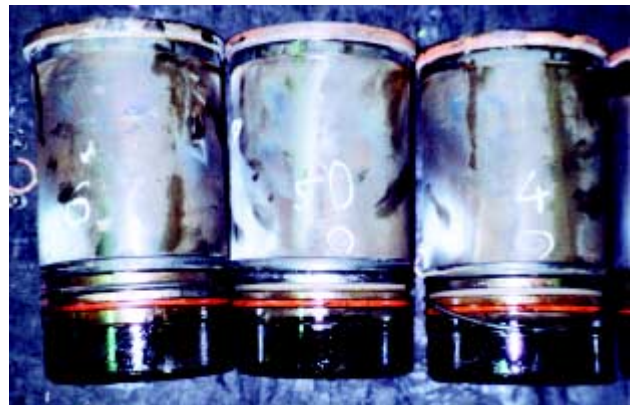
写真7 ノンアミンクーラントフィールドテスト結果
