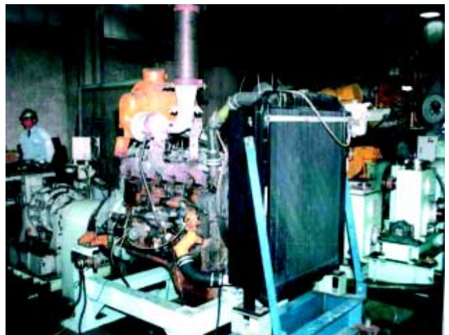
写真4 クーラントエンジンベンチテスト状況
