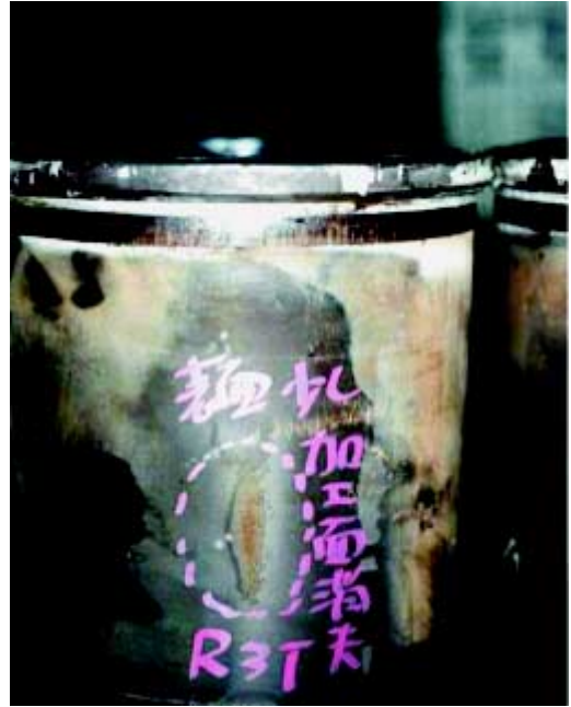
写真3 試作ノンアミンクーラントエンジンテスト結果 (開発初期、ライナーキャビテーションピッチング)
