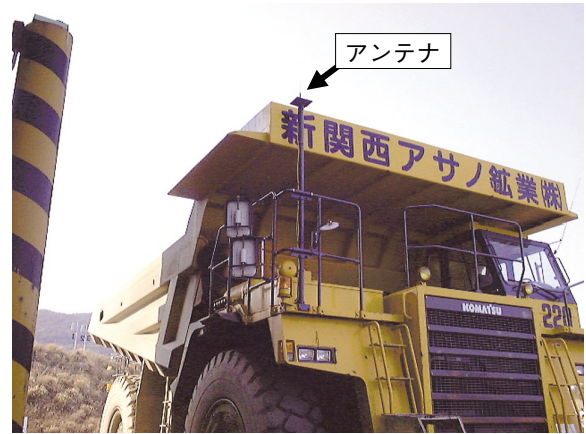
写真1 衛星通信機器車載状況
