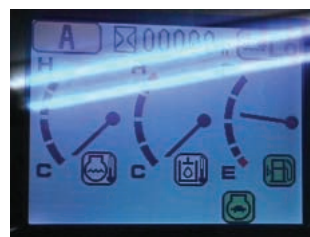
蛍光灯の映り込んだ部分は表示が見えない (b)映り込み低減処理のない液晶窓
