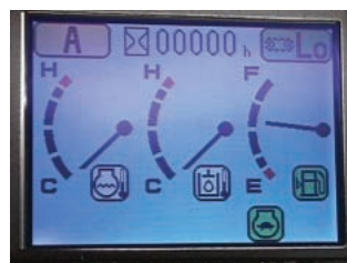
蛍光灯の部分が明るくなるが、表示の認識には問題ない (c)映り込み低減処理をした液晶
