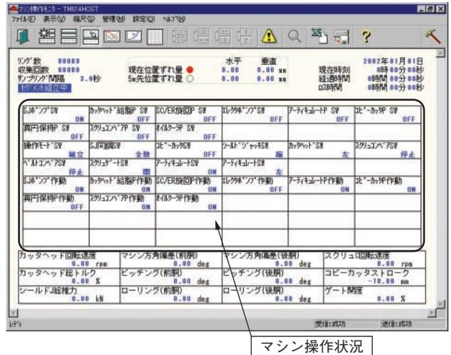
図4 マシン操作モニタ例
