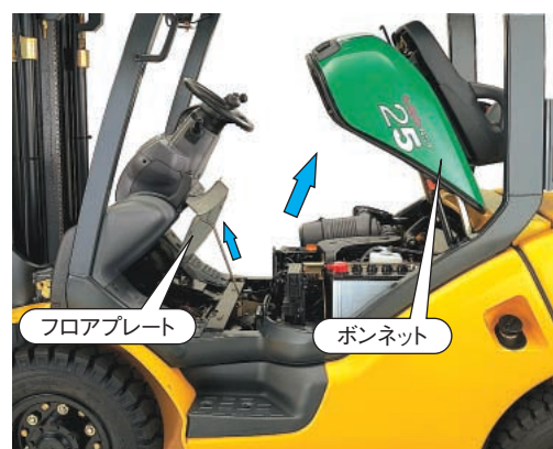
写真10 フロアプレートのオープン構造
