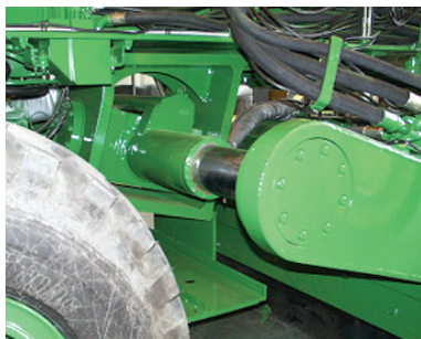
写真2 作業機支持部
