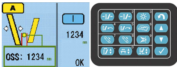
図4 操作盤(隙間調整用)
