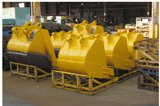
写真1 バケット補修例
