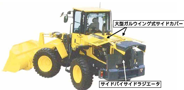
写真9 エンジン回りドア開口
