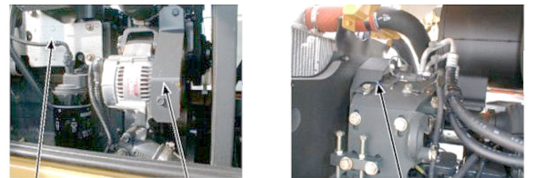
サーマルガード(エキゾーストマニホールド) 回転物ガード(オルタネータ) 回転物ガード(エアコンコンプレッサ)
