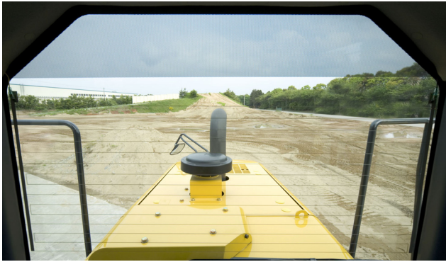
図21 マフラセンタレイアウトとリヤアンダビューミラー
