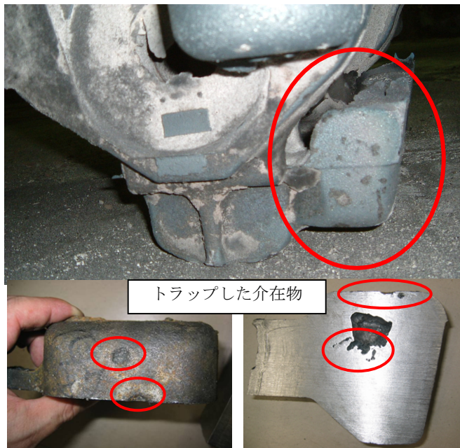
図 18 ボギーの砂止め方案による効果
