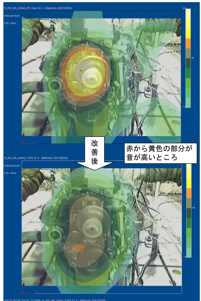
図 14 ビームフォーミングによる音源調査と対応後の様子
