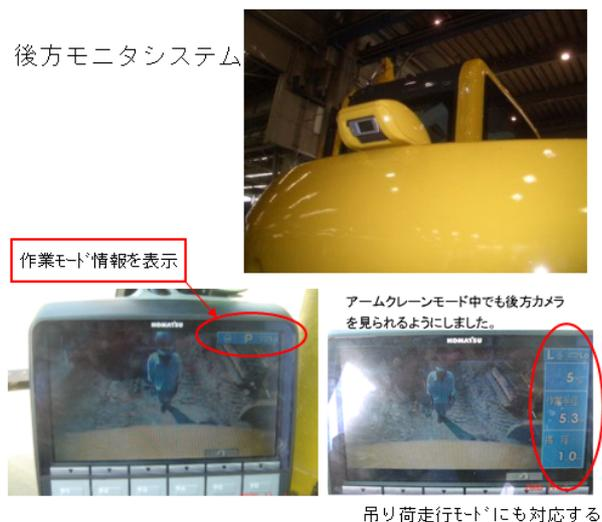
写真2 後方モニタシステム
