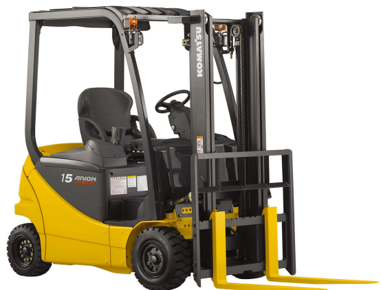
写真3 FB15HB-12 (HYBRID) 1.5t バッテリーハイブリッド車
