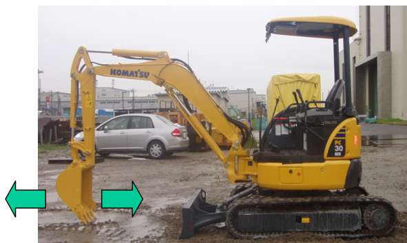
写真3 荒スキ（仕上げ）作業
