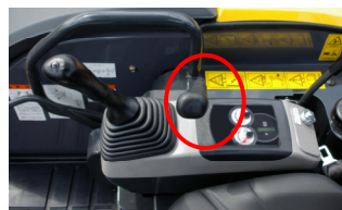
走行自動変速スイッチ移設
