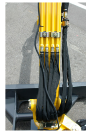
圧油飛散防止カバー
