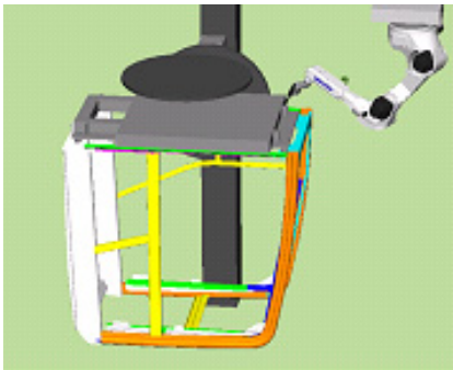
図 21 フロア側溶接
