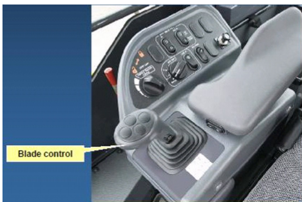
写真2 電気デテント付き電気式モノレバー
