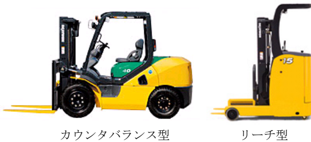
図1 フォークリフトの外観写真
