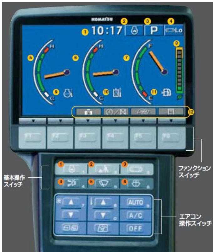
図 15 新大型カラーマルチモニタ, ファンクションスイッチ (PC228US-8 カタログから引用)
