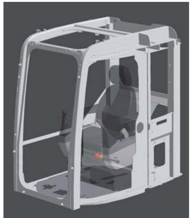
図9 運転車保護構造キャブ
