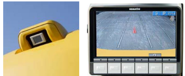
図12 後方監視モニタシステム (PC228US-8 カタログから引用)
