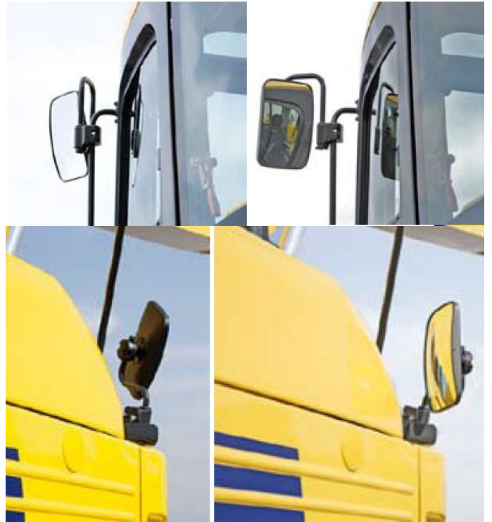
図11 可倒式大型ミラー (PC228US-8 セールスマニュアルから引用)
