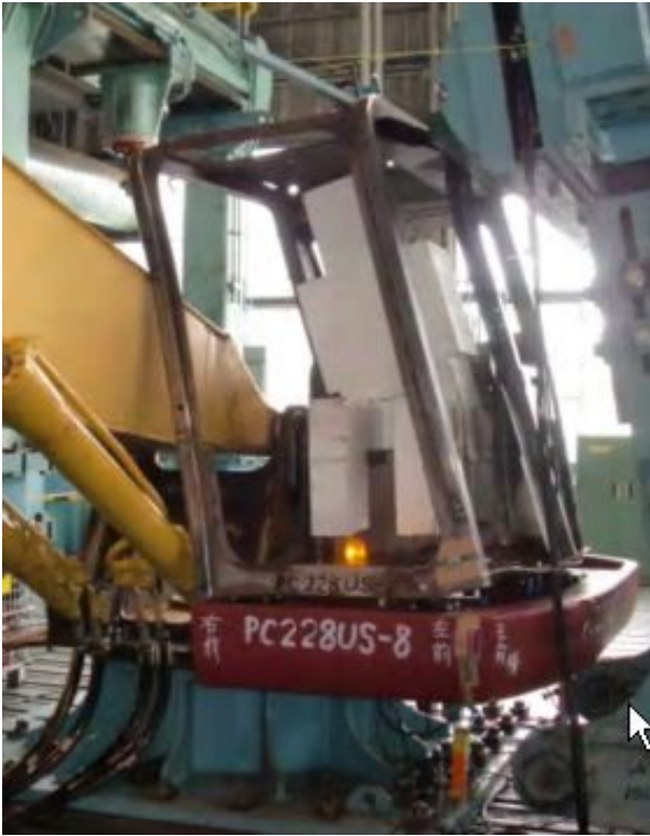
図10 運転車保護構造キャブ (試験報告書から引用)
