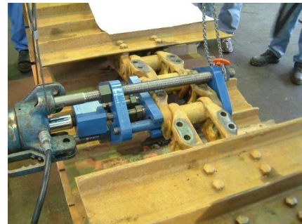
(1) シューを外し、専用治具を取り付ける。
