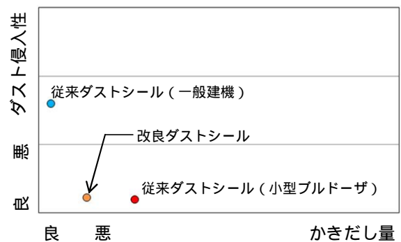
図4 ダスト侵入性とかきだし性評価
