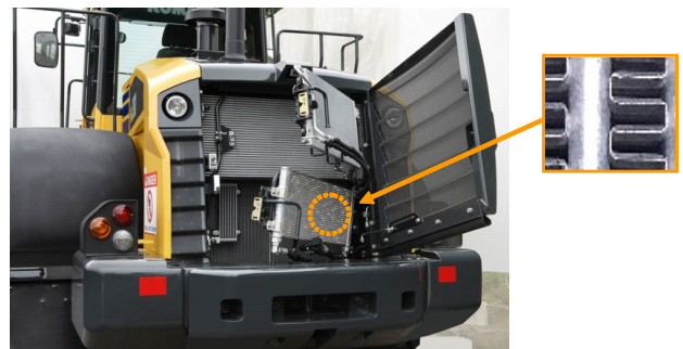
図 18 スイングアウト型リアグリル&クーリングユニット
