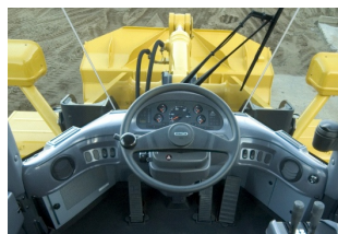
図7 新デザインキャブ(7型と6型の比較)
