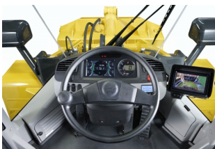
図7 新デザインキャブ(7型と6型の比較)
