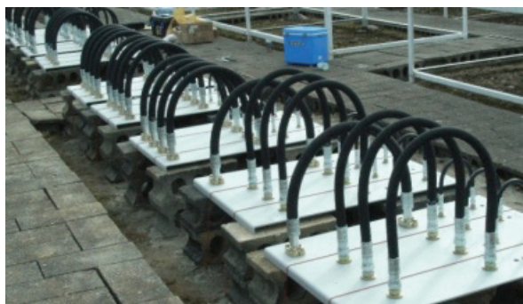
図3.8 ホースの暴露試験（1年間）
