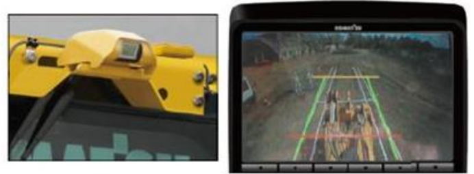
図11 後方視認用カメラとカメラ画像
