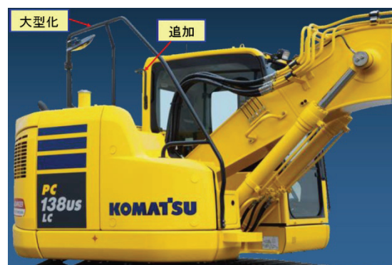
図 13 マシンキャブからの落下防止用手すり
