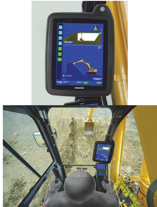
図 7 大画面コントロールボックス
