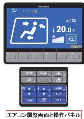
エアコン調整画面と操作パネル
