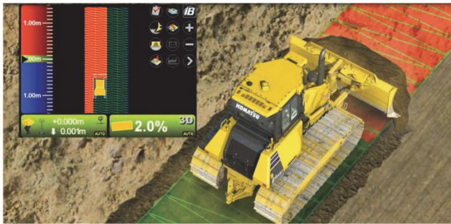
図3 ICTブルドーザー3次元施工データ
