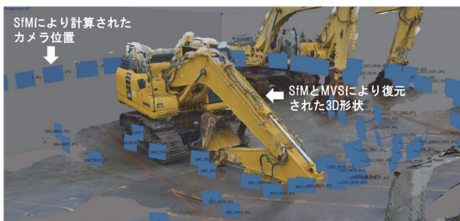
図 5 SfM&MVS による形状計測 (Agisoft 社 PhotoScan)
