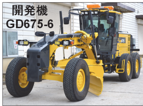
3.7m級除雪グレーダ オプション:4.0m,4.3mブレードを用意
