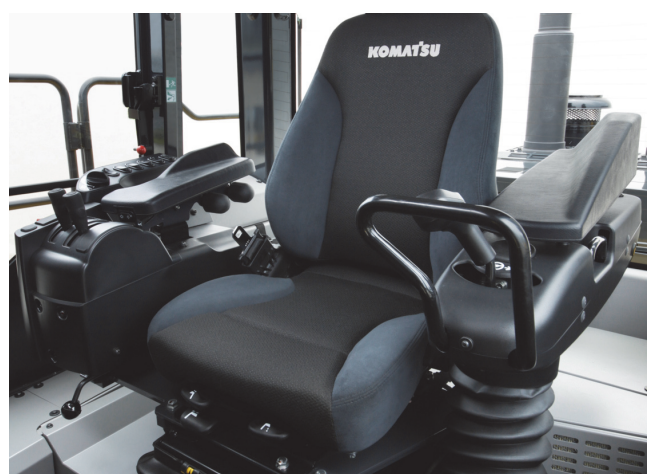
図7 作業機・Advanced Joystick Steering System 一体化オペレータシート
