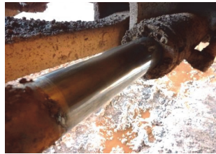
図3 HVOF溶射シリンダロッド
