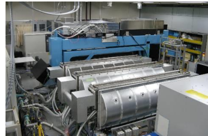
図 7 CO 2 増幅実験装置 (三菱電機㈱提供)
