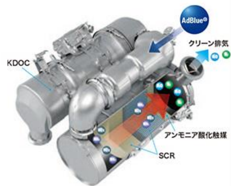
図2 排出ガス後処理装置
