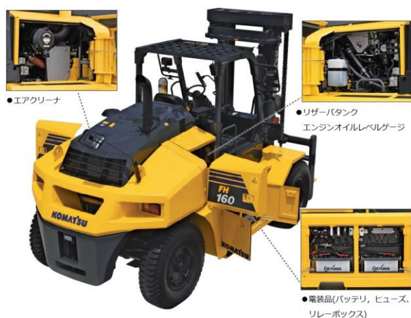
図15 大型点検カバー
