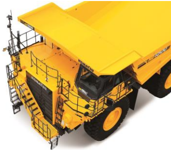
図 8 昇降用斜め階段
