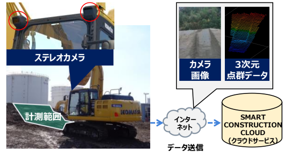
図3 ステレオカメラシステムの概要
