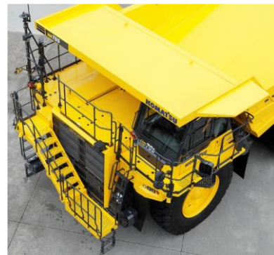
図6 昇降用斜め階段
