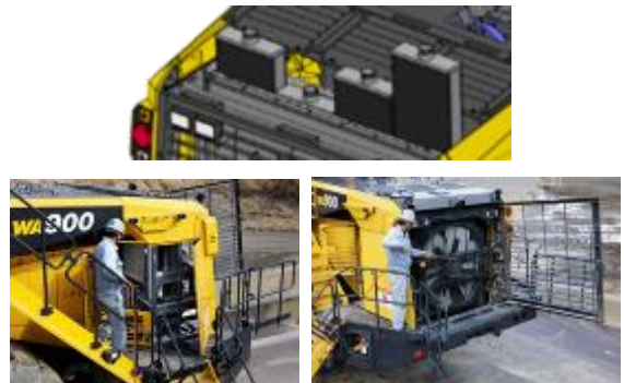
図 16 ラジエータコアメンテナンス
