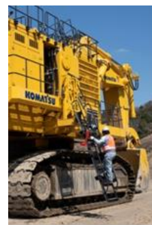
緊急脱出ラダー
