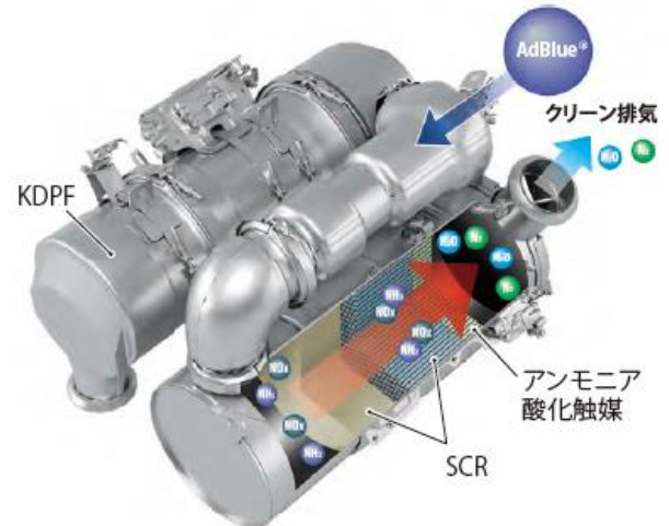
図4 排ガス後処理システム
