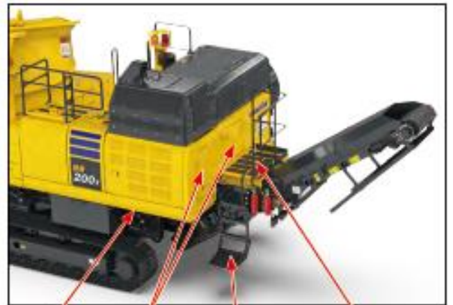
ダストシュート 清掃用ドア ステップ 清掃用プラットフォーム
