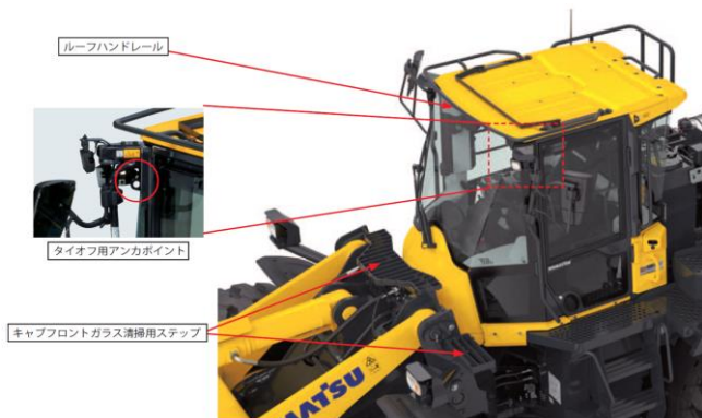
図 24 フロントガラス清掃用ステップ
