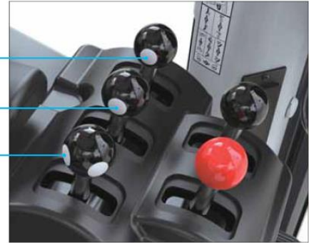
図 13 マシンコントロール用操作スイッチ
