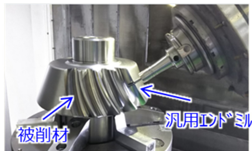
図3 汎用エンドミルを使ったピニオンの5軸加工
