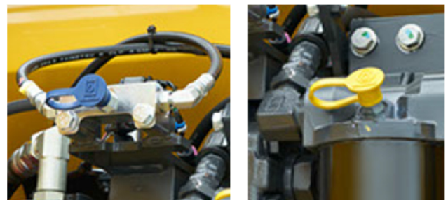
図10 オイルサンプリングポート （左：作動油用、右：エンジンオイル用）
