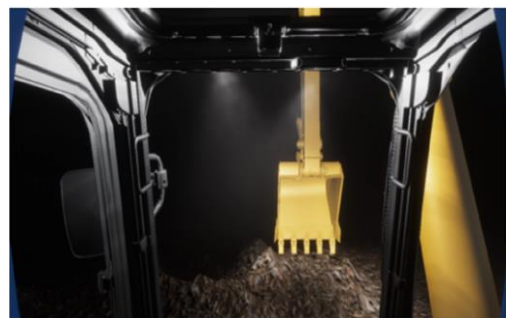
図13 夜間視界性評価のシミュレーション例
