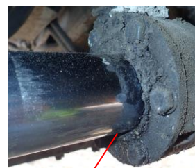
図6 ロッド傷による油漏れ
