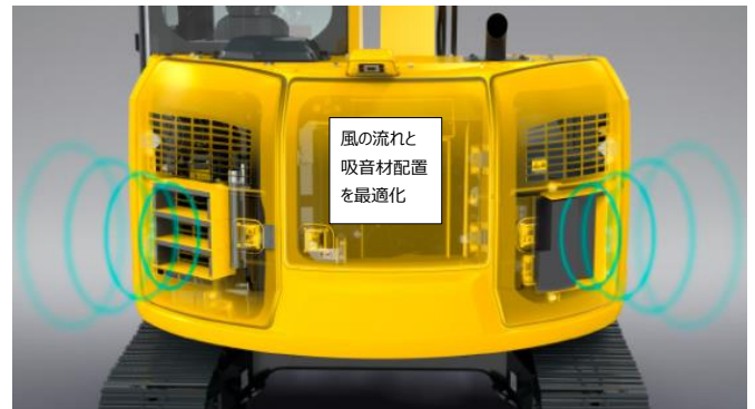
図8 外装構造変更による騒音低減
