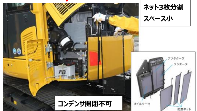
図15 現行機の外装構造
