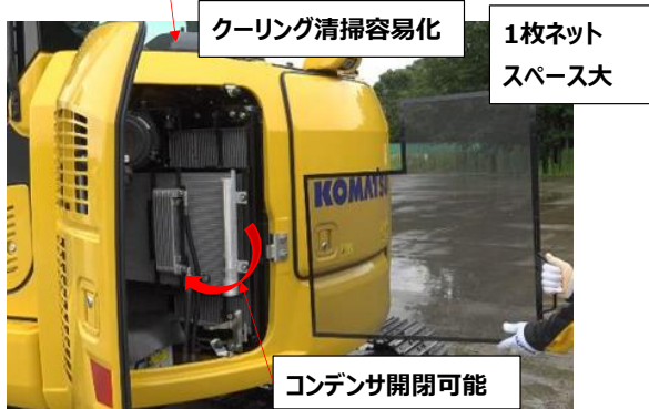
図14 開発機の外装構造
