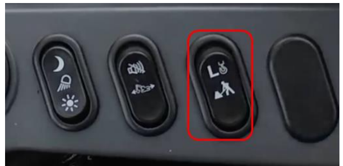
図12 アームクレーンワンタッチ切替スイッチ
