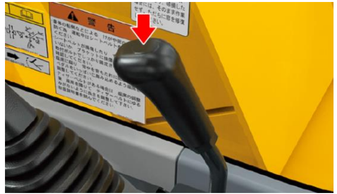
図11 ブレードレバーに追加した走行切替スイッチ
