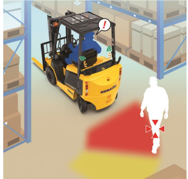
図2 FE25/30-2衝突検知警報システム搭載車両 (安全小冊子より引用)
