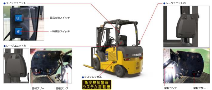
図3 衝突検知警報システム外観（FE25/25H/30-1） （安全小冊子より引用）
