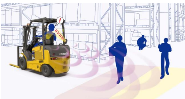
図1 FE25/25H/30-1衝突検知警報システム搭載車両 (安全小冊子より引用)
