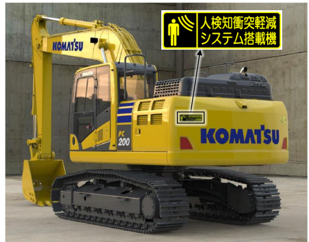
図4 KomVision人検知衝突軽減システム搭載のPC200-11外観（デカールが追加される）
