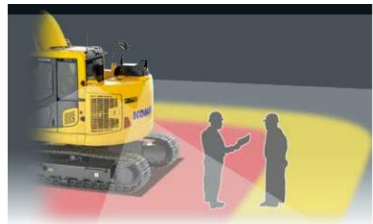
＜参照＞コマツカスタマーサポート カタログより 図16 PC138US-11へ人検知衝突軽減システム適用
