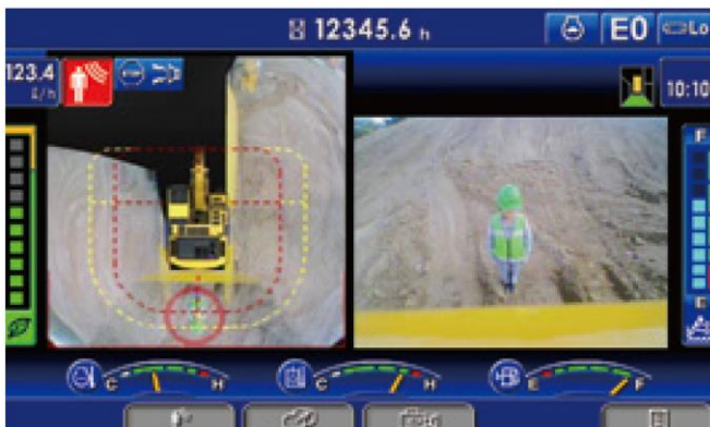
＜参照＞KomVision人検知衝突軽減システム安全小冊子より 図6 人検知衝突軽減システムのモニタ表示
